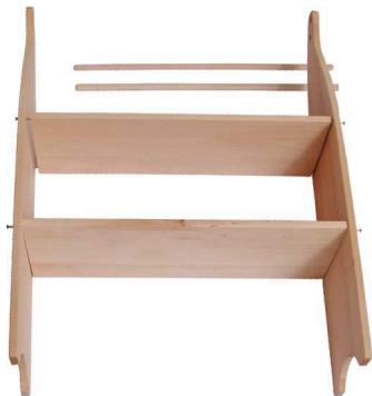
Das zweite Seitenteil A wird auf der anderen Seite der Querbretter B, C und D mit insgesamt 5 langen Schrauben locker befestigt.
