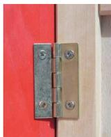
Die Seitenteile H werden an ihren Scharnieren mit kleinen Schrauben am Kaspertheater befestigt. Die Löcher für die Schrauben sind an den Seitenteilen B vorgebohrt.
